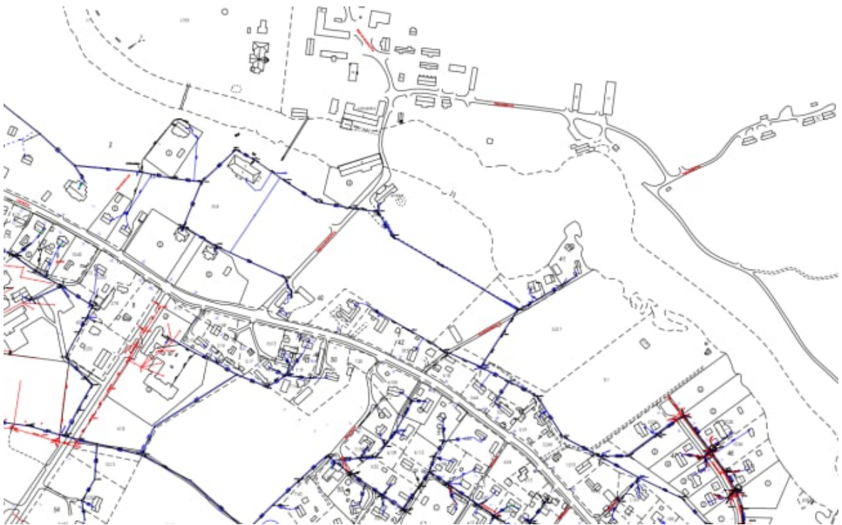
Kuva 29. Vesijohto ja viemäri.
