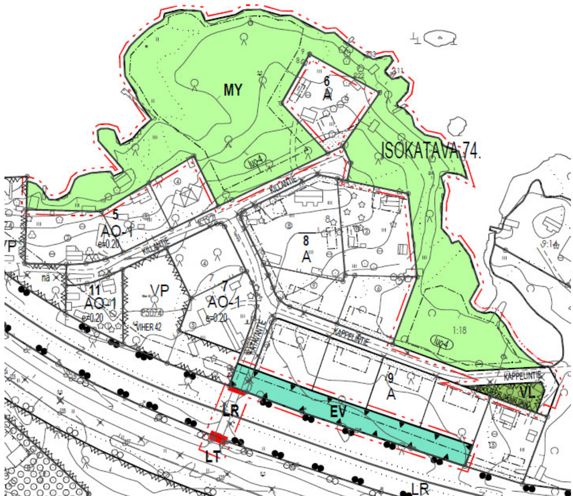
Kuva 14, ote ehdotusvaiheen muutoskaavasta. Maa- ja metsätalousalue laajenee maankohoamisen vuoksi siirtyneelle rantaviivalle ja Suojaviheralue katkaisee Katavantien katualueen rautatietasoristeyksen kohdalta.
