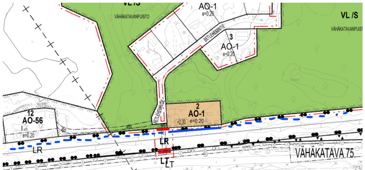
Kuva 6, mahdollisen tärinävaimennuksen sijainti rata-alueen reunassa merkitty sinisellä viivalla, pisteillä merkitty mahdollinen jatke tärinävaimennukselle, jolloin se palvelisi paremmin koko lähialuetta.
