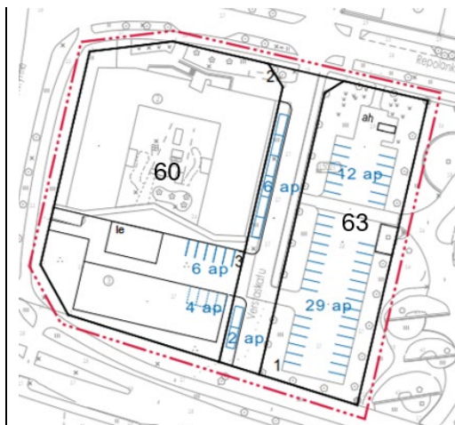
Kuva 13. VE 2b: Verstaskadun varteen pitkittäisiä autopaikkoja (b) yhteensä 59 autopaikkaa, joista yleiseen pysäköintiin 21 autopaikkaa.
