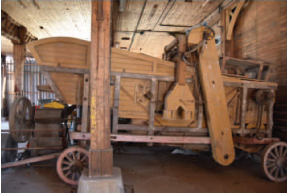
Puimuritehtaan puutyöosasto valmisti puimakoneiden puuosia. Sampo 75 puimakone on säilytyksessä vanhassa saharakennuksessa.
