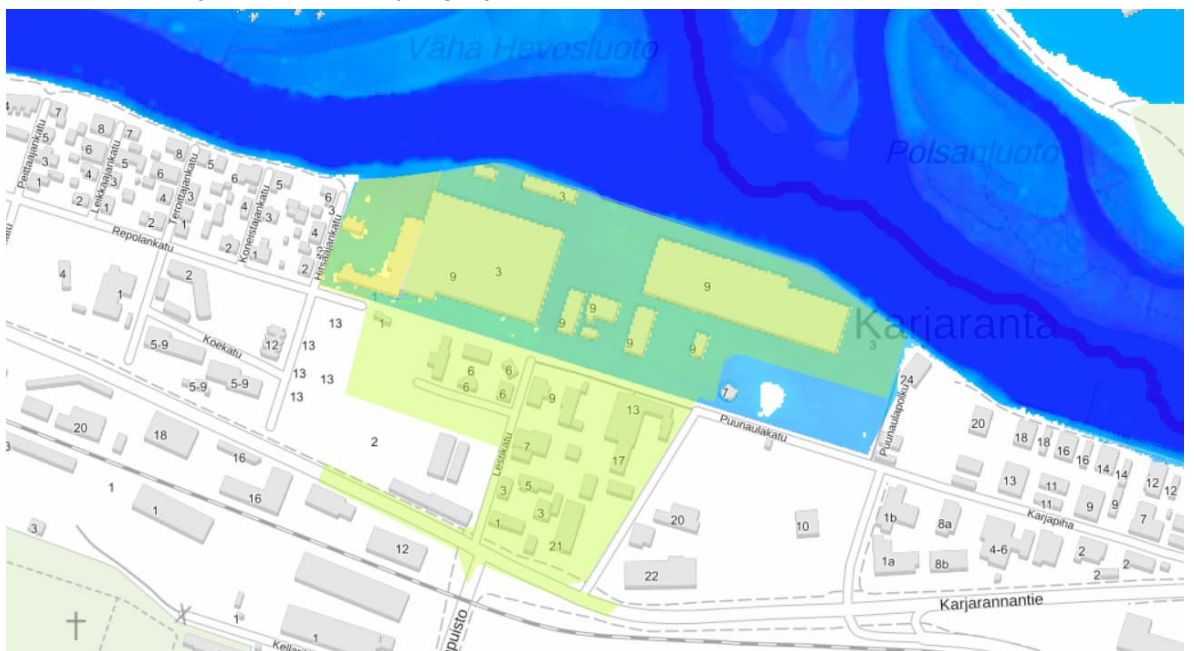
Kuva 22, tulvasuojaus tehty, vedenkorkeus +3,15 m N2000, 1/250a.
