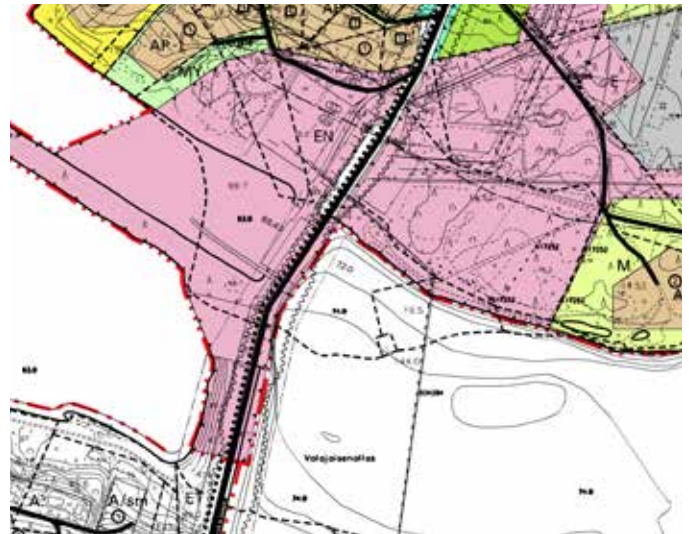
Kuva 6. Hirvaan osayleiskaavavaluonnoksessa on osoitettu EN-merkinnällä myös voimalaitosalueelta lähtevät useat voimajohdot osana laajaa energiahuollon toimintojen kokonaisuutta. Aluekokonaisuus sisältää myös sähköaseman ja voimalaitoksen rakenteineen. (Rovaniemen kaupunki 2009).
