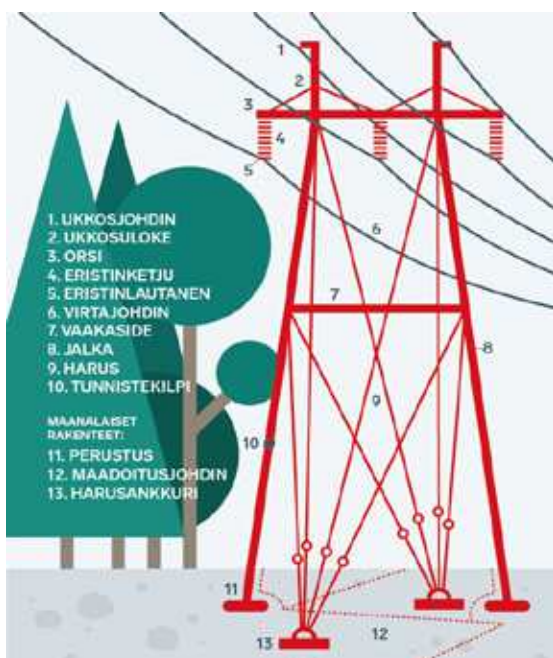
Kuva 2. Voimajohdon ja johtoalueen osat.
