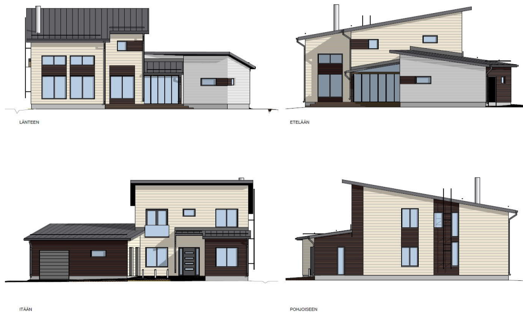
Kuva 13: Esimerkki onnistuneista nykyaikaisen pientalon puujulkisivuista. Arkkitehtuuri kuvastaa rehdisti talon rakentamisaikaa. Yksikään julkisivu ei ole ruma eikä tylsä. Isot ulkoseinäpinnat on jäsennöity varioimalla puupinnan struktuuria ja väriä. Värikokonaisuus on raikas ja harmoninen, mutta ei levoton. Kattomuodoksi on valittu pulpettiharja, jota sommittelussa toistetaan sisäisesti johdonmukaisella tavalla. Plania Amanda v 2015, Planiatalo oy .
