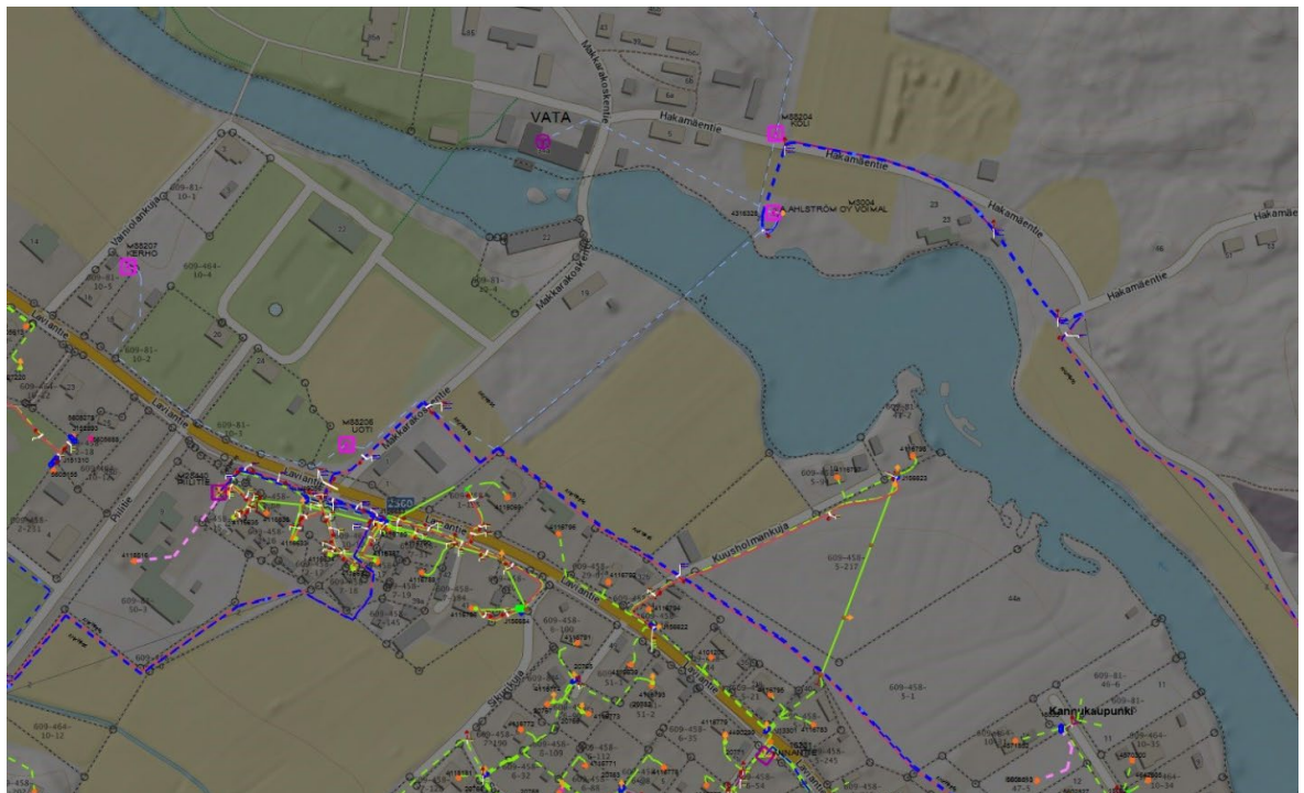
Kuva 14. Sähköverkosto (Caruna, 2022), suunnittelualueella on maanlaisia sähköjohtoja.
