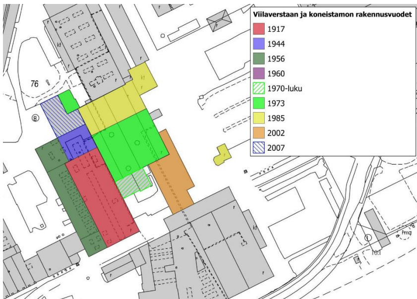
Kuva 16. Viilaverstaan ja koneistamon rakennusvaiheet. Porin Konepajan ja Isosannan sahan rakennusinventointi (Porin kaupunkisuunnittelu 2022).
