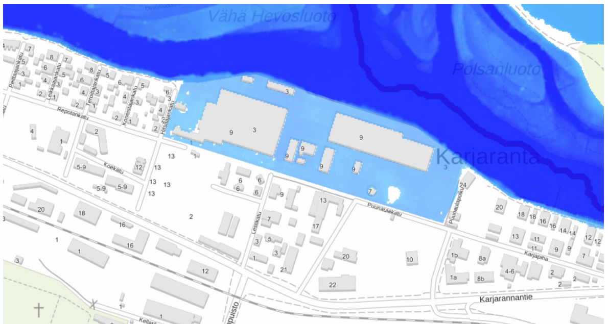
Kuva 10, tulvasuojaus tehty, vedenkorkeus +3,15m N2000, 1/250a.
