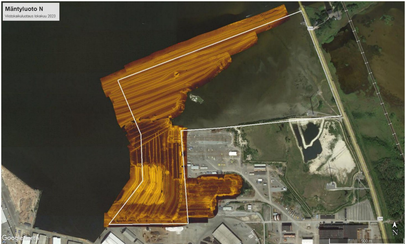
Kuva 13. Mosaiikkikuva viistokaikuluotausaineistosta Mäntyluodon pohjoispuolelta. Alueen pinta-ala on 93ha. Alue, jossa mosaiikkia ei näy, on liian matalaa luotaukseen.
