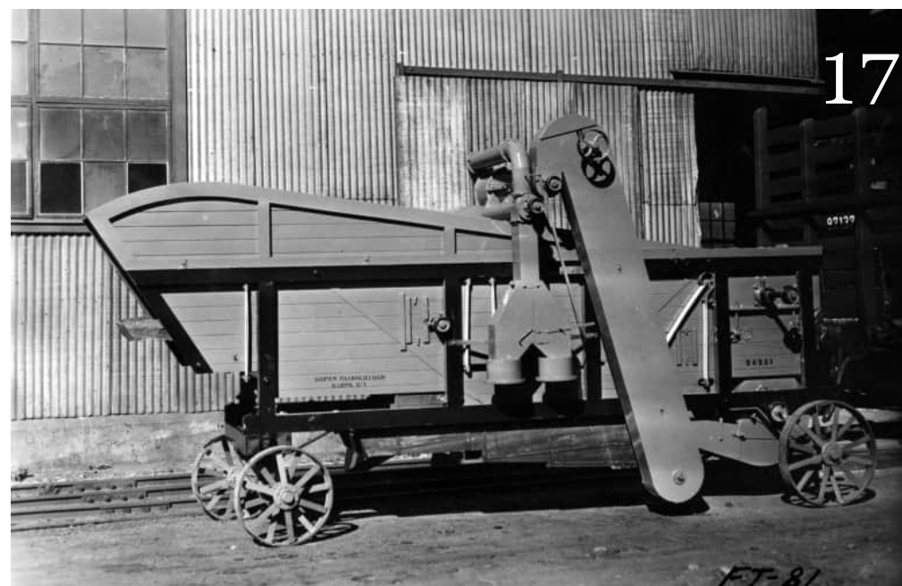
Kuva 17. Puinen Sampo-puimakone vastasi vasta itsenäistyneen Suomen maatalouden kehitykseen ja koneistumiseen. Kuva: Rosenlew-museon kokoelmat.
