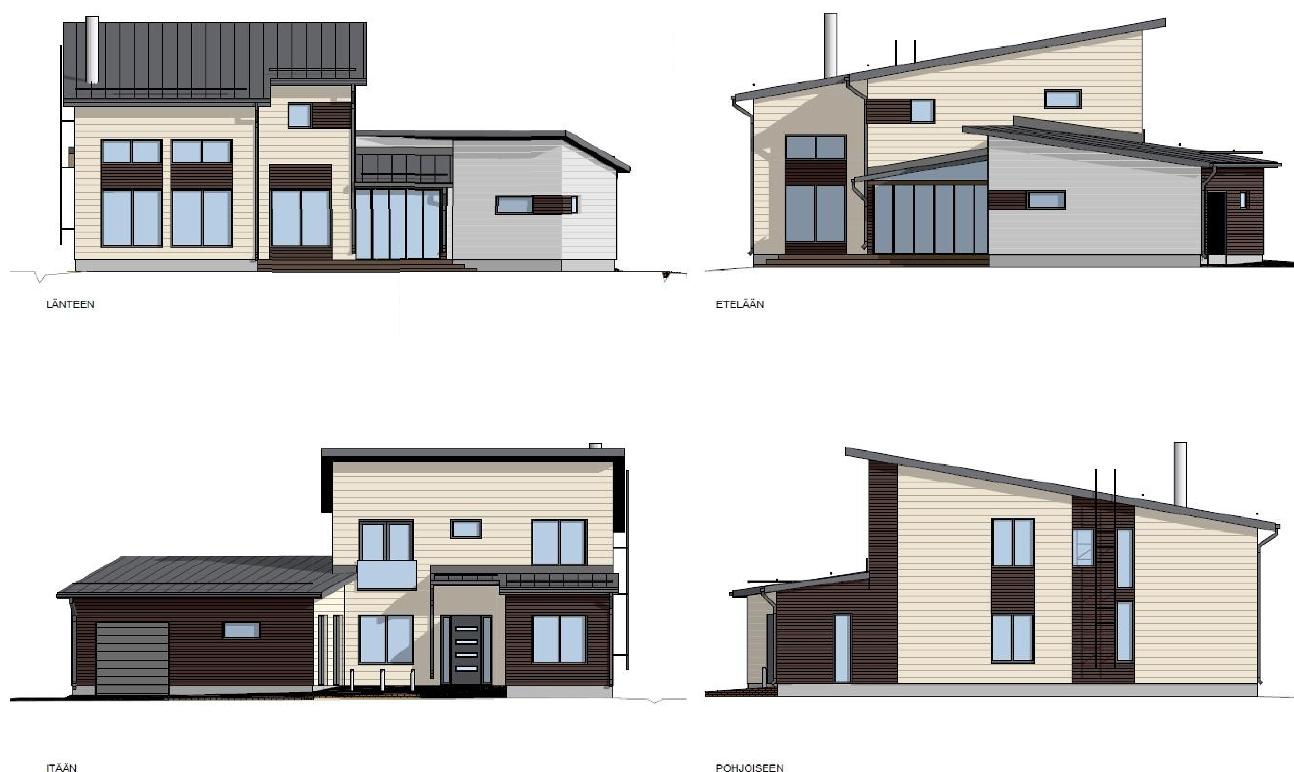
Kuva 12: Esimerkki onnistuneista nykyaikaisen pientalon puujulkisivuista. Arkkitehtuuri kuvastaa rehdisti talon rakentamisaikaa. Yksikään julkisivu ei ole ruma eikä tylsä. Isot ulkoseinäpinnat on jäsennöity varioimalla puupinnan struktuuria ja väriä. Värikokonaisuus on raikas ja harmoninen, mutta ei levoton. Kattomuodoksi on valittu pulpettiharja, jota sommittelussa toistetaan sisäisesti johdonmukaisella tavalla. Plania Amanda v 2015, Planiatalo oy .
