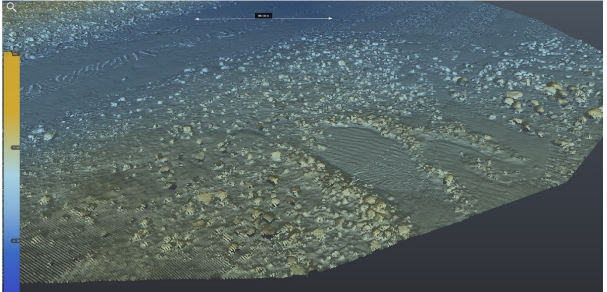
Kuva 7-7. Hankealueelta oleva monikeilaluotauskuva esittää alueelle tyypillistä merenpohjaa. Hankealueella merenpohjan kohoumat ovat kivikkoista ja lohkeista hiekkamoreenia. Paikoittain saattaa esiintyä hiekkalaikkuja. Kohoumien alarinteessä kivikkoinen moreeni vaihettuu hienompiin ja löyhempiin kitkamaalajeihin. Syvänteissä esiintyy myös koheesiomaalajeja.
