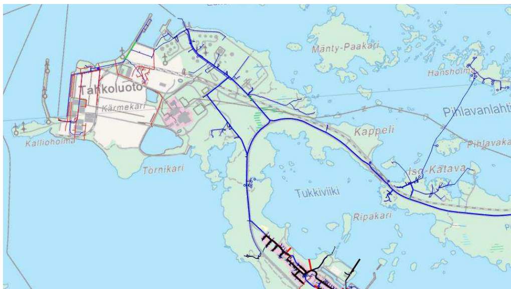
Kuva 42. Ote vesihuollon verkostokartasta. Sinisellä puhdas vesi, punaisella sadevesiviemäri ja mustalla jätevedet. Tahkoluodon sataman alueella on oma jätevesijärjestelmä, mikä ei näy tietokannassa.
